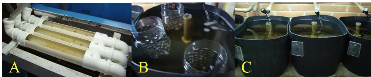
Figura 3 – Fotos dos sistemas de cada tratamento: A) T1 (RCY) Raceway em PVC com volume total de 1L; B) T2 (PET) Garrafa PET furada com volume de 1L, submersa em tanque semi-circular de polietileno com volume de 30L; C) T3 (AQU) Tanques semi-circulares de polietileno com volume de 30L. (Fonte: arquivo pessoal do autor).
